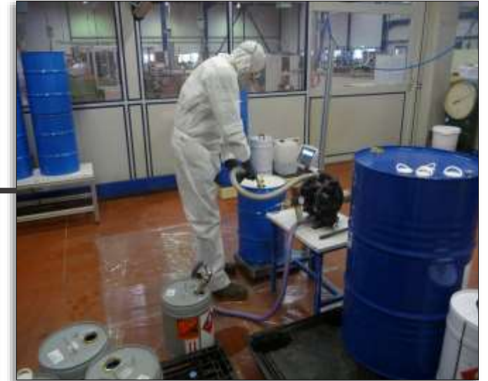
----- Remplissage liquide/semi-pâteux/pâteux avec précision à 0,2% -----
