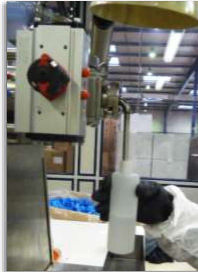
----- Remplissage liquide/semi-pâteux/pâteux avec précision à 0,2% -----
