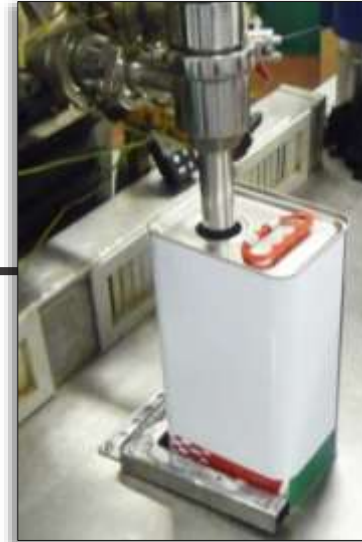
----- Remplissage liquide/semi-pâteux/pâteux avec précision à 0,2% -----
